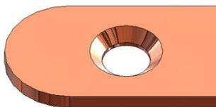
Рис. 4 Крепление проводника
